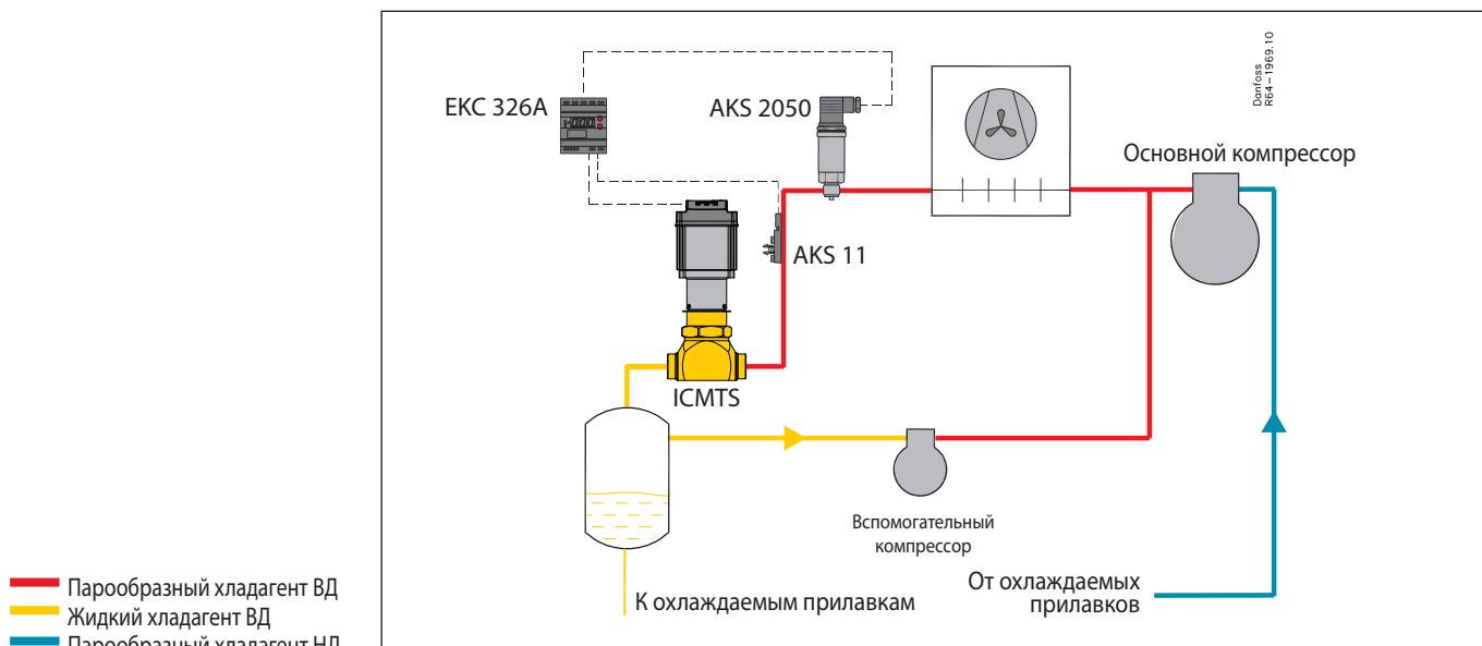
Рис. 1.3.4: Регулирование промежуточного давления при помощи вспомогательного компрессора.
